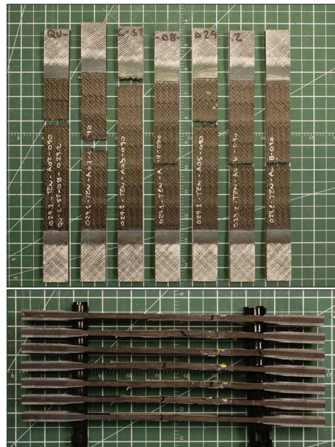
Figure 4.2 Exemple de spécimens de tension post-mortem
