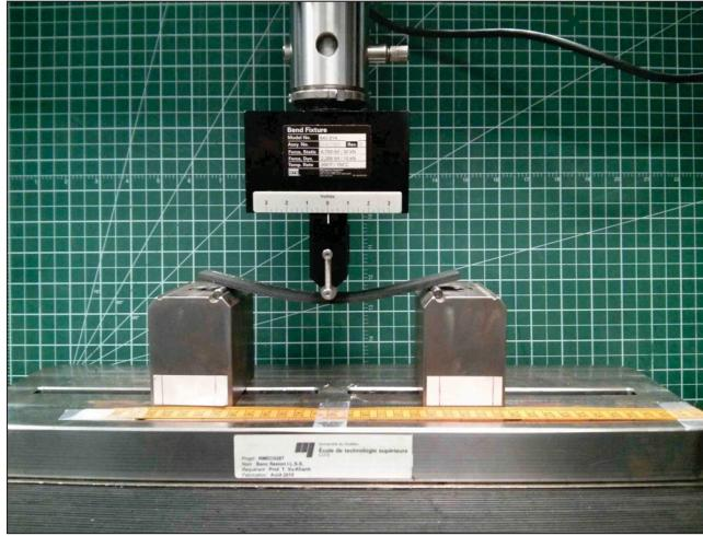
Figure 4.9 Montage de l'essai de flexion 3 point
