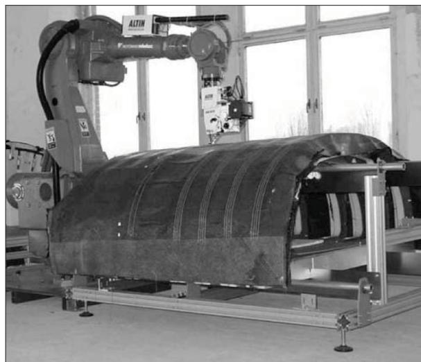
Figure 1.21 Couture d'une préforme de grande dimension à l'aide d'une tête de couture aveugle opérée par bras robotisé
