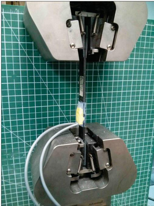
Figure 4.1 Montage de l'essai de tension
