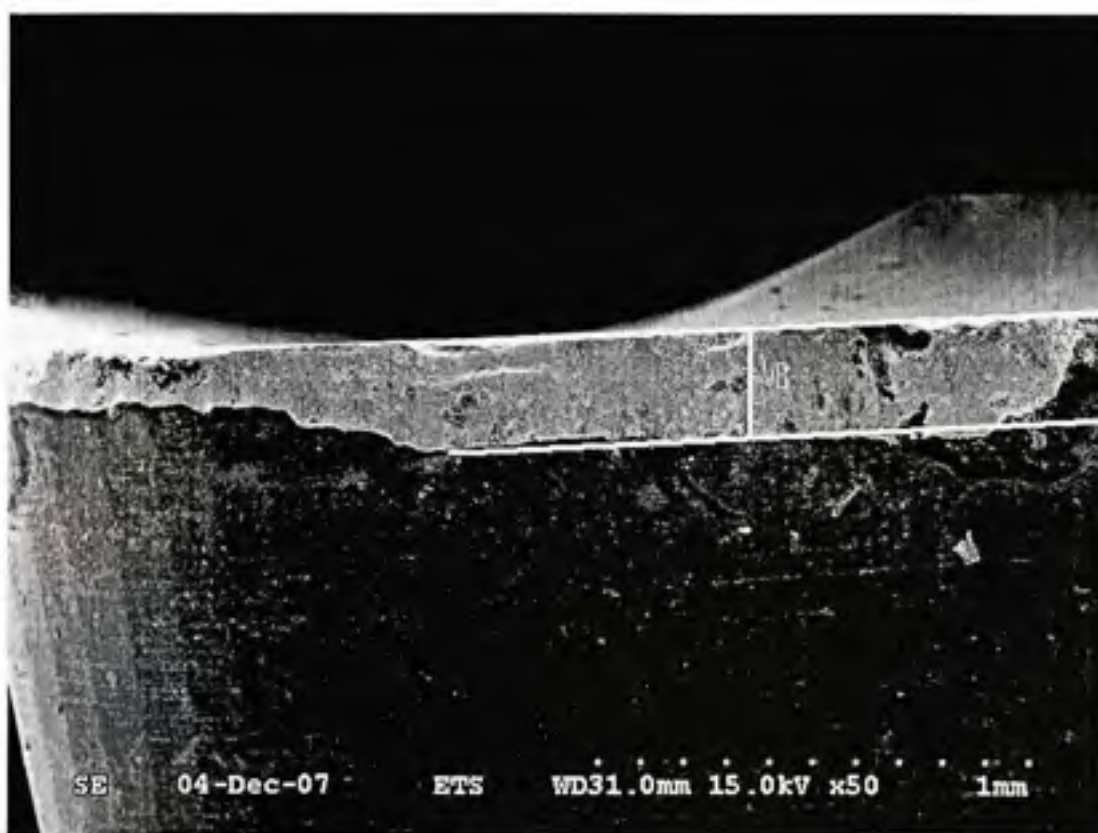
Figure 3.9 Usure en dépouille de l'outil ( V_B ).
