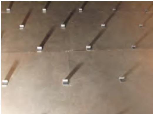
FIGURE 2.3 – Photographie des éléments de rugosité disposés au sol
