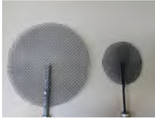
FIGURE 5.1 – Les deux disques actuateurs poreux utilisés, de diamètres D = 10\text{cm} et D = 20\text{cm}
