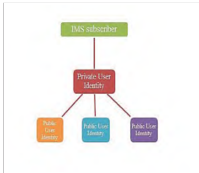
Figure 2.4 Relation entre l'identité privée et public dans IMS Tirée de MROUEH Lina (2006)
