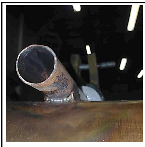
Figure 46 : Vue de face de la brasure
