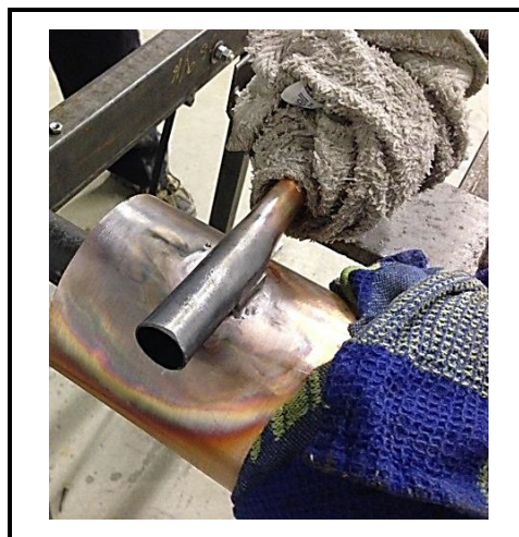
Figure 45 : Montage après le brasage
