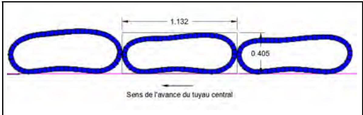
Figure 39 : Section enroulement hélicoïdal sur 3 tours
