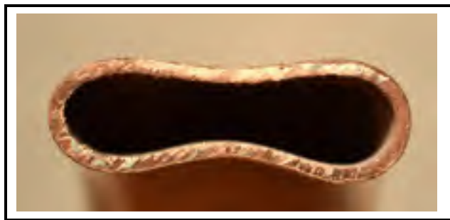
Figure 2 : Section du tube enroulé lors d'essais préliminaires
