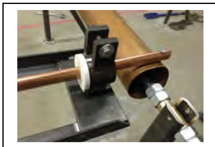
Figure 19 : Montage d'enroulement du tube préformé
