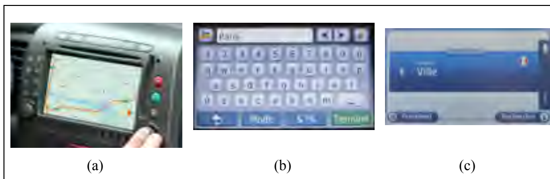
Figure 1.3 Intégration fonctionnelle : dématérialisation d'une fonction de saisie d'adresse sur un GPS automobile 3
