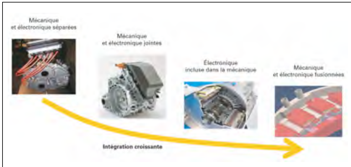
Figure 1.4 Les différents niveaux d'intégration pour les produits mécatroniques (Penas et al., 2010)
