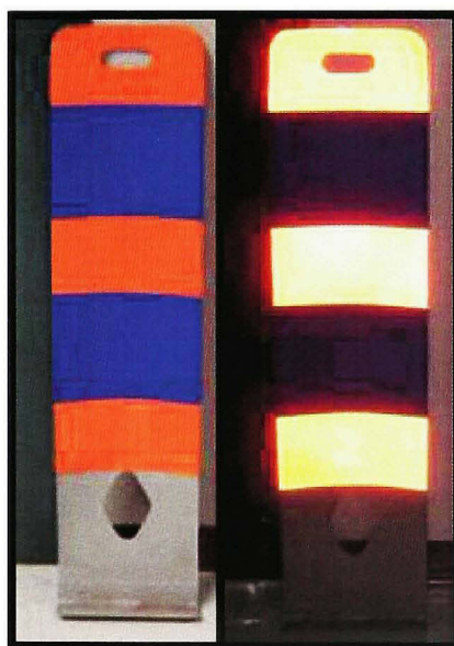
Figure 3.9 ÉTS 2 : T-RV-8 modifié en bleu non rétro réfléchissant (Quatre bandes orange rétro réfléchissantes 150 mm). (Groleau, 2006)
