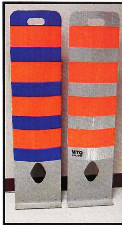
Figure 3.7 T-RV-8 modifié en bleu et T-RV-8 standard. (modifié préféré à 10 contre 5) (Groleau, 2006)
