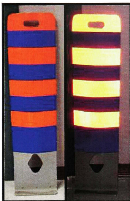
Figure 3.8 ÉTS 1 : T-RV-8 modifié en bleu non rétro réfléchissant (Quatre bandes orange rétro réfléchissantes 100 mm). (Groleau, 2006)
