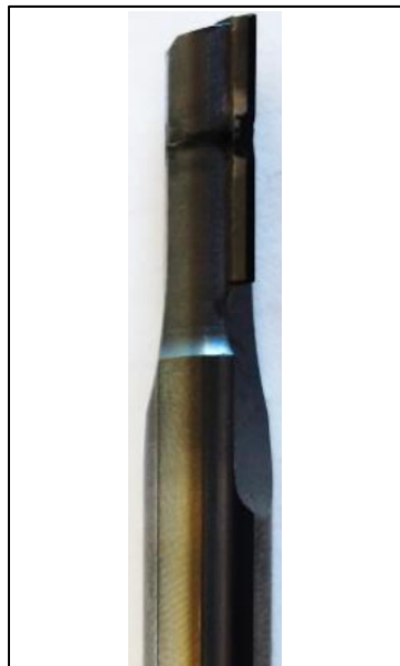
Figure 2.32 : Outil avec plaquettes diamant PCD
