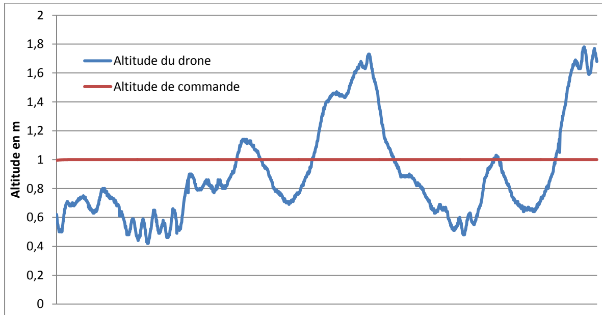
Figure 6.1 Test de maintien d'altitude avec PID
