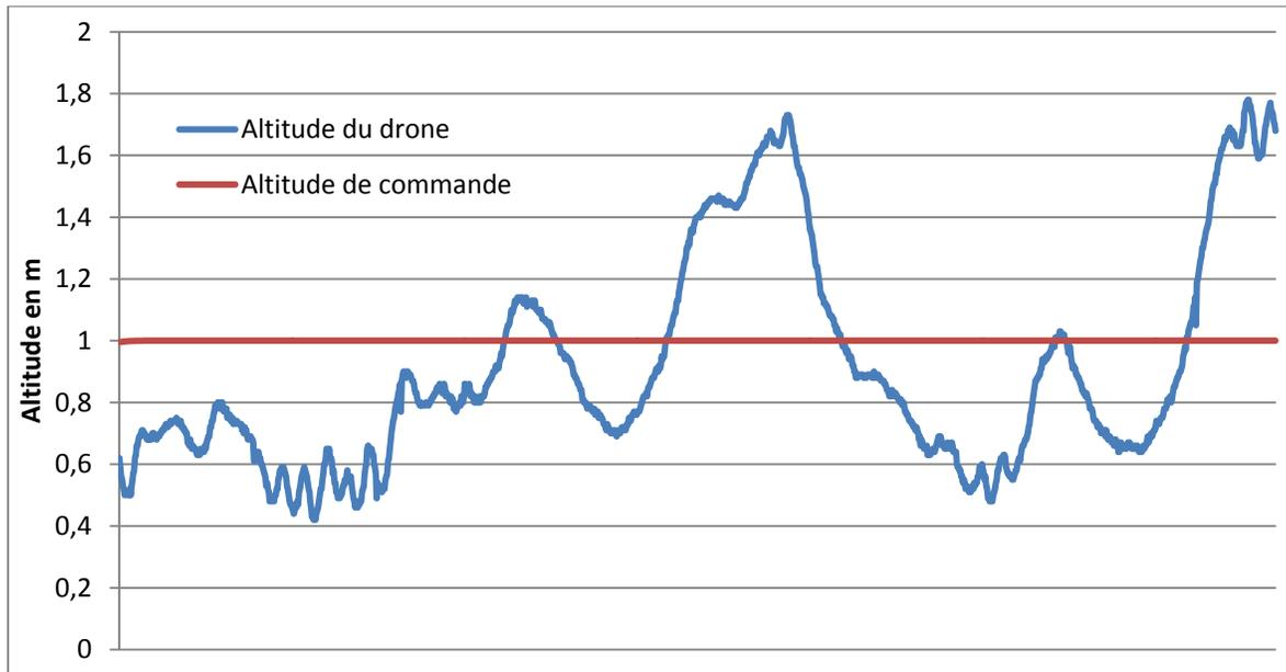
Figure 6.1 Test de maintien d'altitude avec PID
