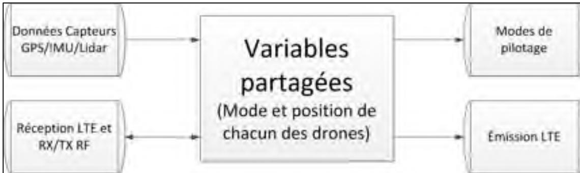
Figure 4.26 Architecture du partage de données entre applications
