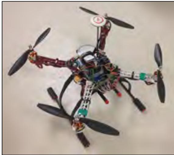
Figure 4.9 Prototype du F450 modifié à la saveur du projet
