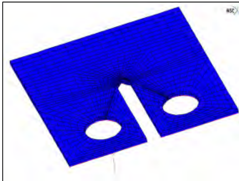
Figure 3-4 Conditions aux frontières appliquées au spécimen compact de tension
