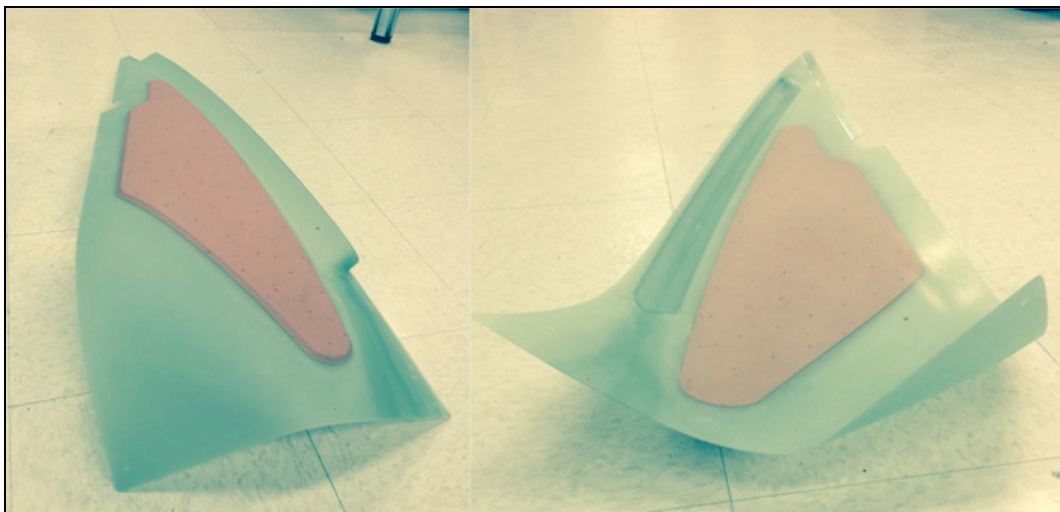
Figure 3.30 Pièce typique avec un noyau en mousse
