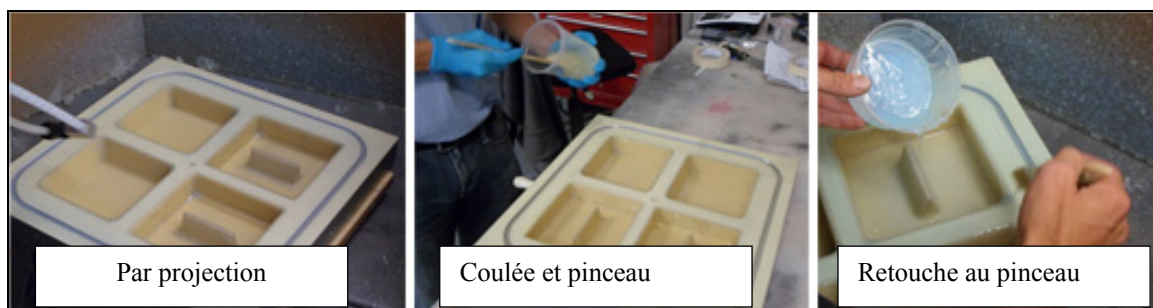
Figure 3.5 Moule de torture, fabrication des membranes
