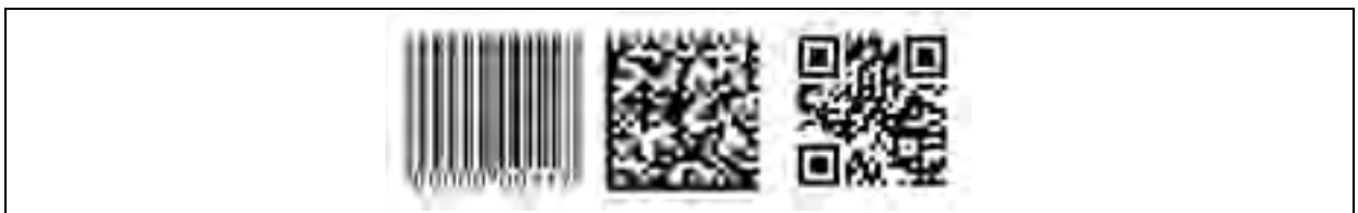
Figure 2.5 Code-barres 1D et Code-barres 2D : Datamatrix et QR Tirée de (Aryx, 2010)
