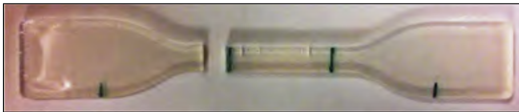
Figure 2.7 : Éprouvette issue de la première série d'essais de fatigue
