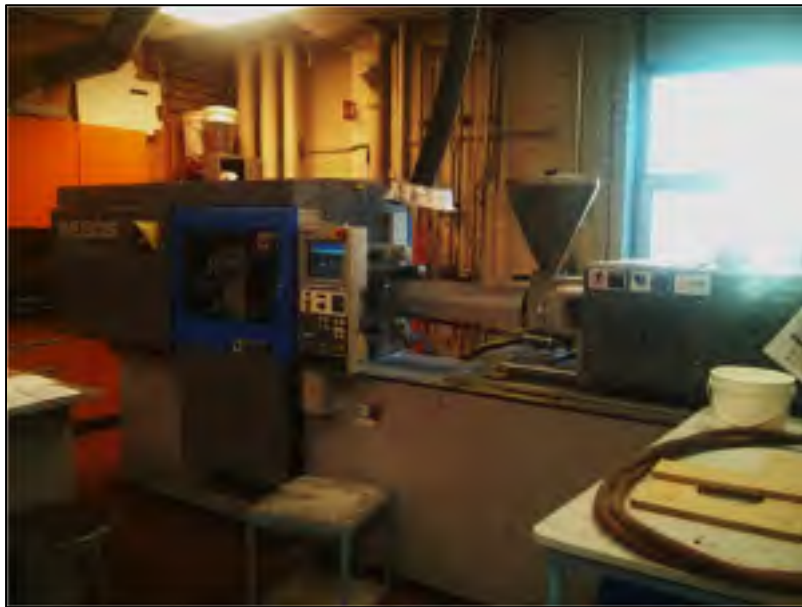
Figure 3.1 : Presse à injection plastique Sumito SE 50S
