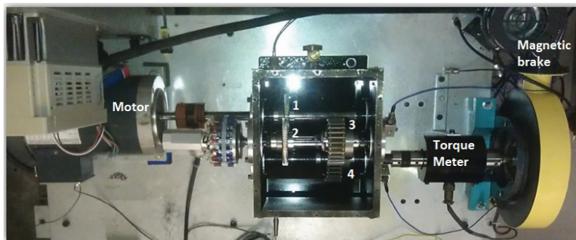
FIGURE 5.2 – Le banc d'engrenages Spectra-Quaest après les modifications.
