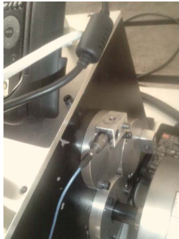
FIGURE A.2 – Position de l'accéléromètre.
