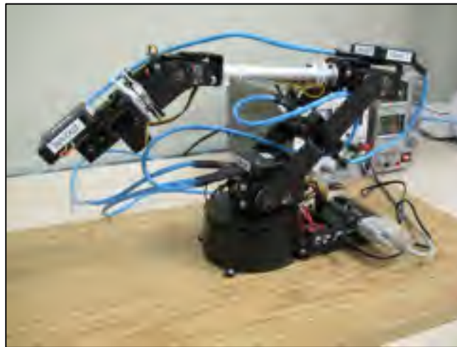
Figure 4.1 Photo du robot de calibration Lynxmotion AL5D équipé avec des IMUs
