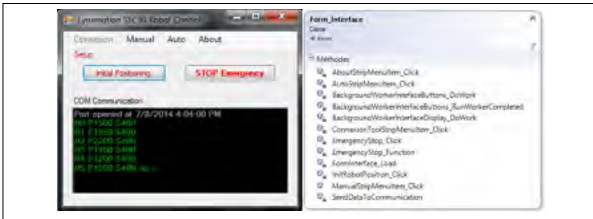
Figure 4.2 Liste des fonctions et imprime écran de l'interface principale
