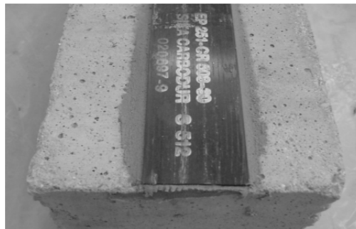
(b) Système préfabriqué collé sur la surface Tirée de Bank (2006)
