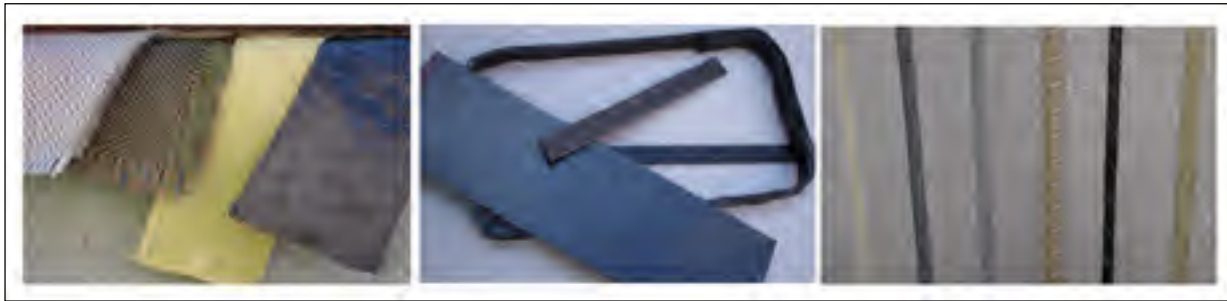
Figure 2.4 Types de PRF : (a) tissus, (b) lamelles, et (c) barres Tirée de FIB TG9.3 (2001)
