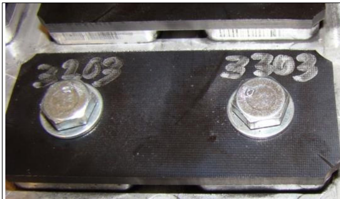
Figure 3.96 Échantillon CFRP rainuré et installé sur le gabarit d'usinage sur le pli inférieur avec le pli noir supérieur visible
