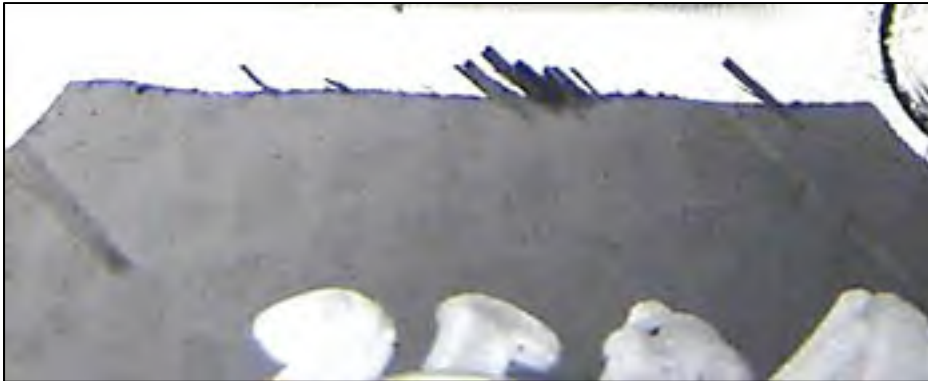
Figure 3.144 FNC délaminiées au-delà de la surface rainurée en avalant pour 200 m/min et 0.41 mm/rev, OP10P4 45° CR10 Y
