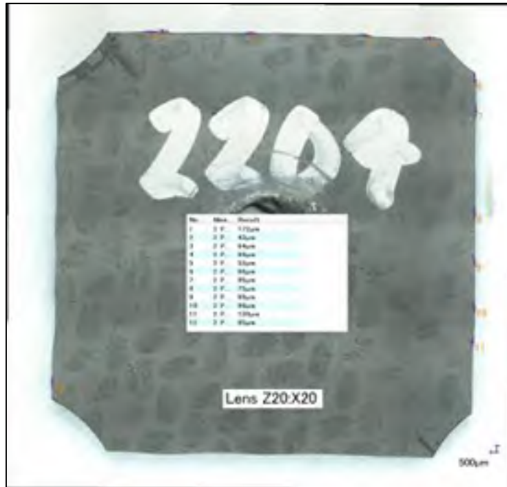
Figure 3.95 Vue normale aux plis d'un échantillon par le microscope VHX 2000
