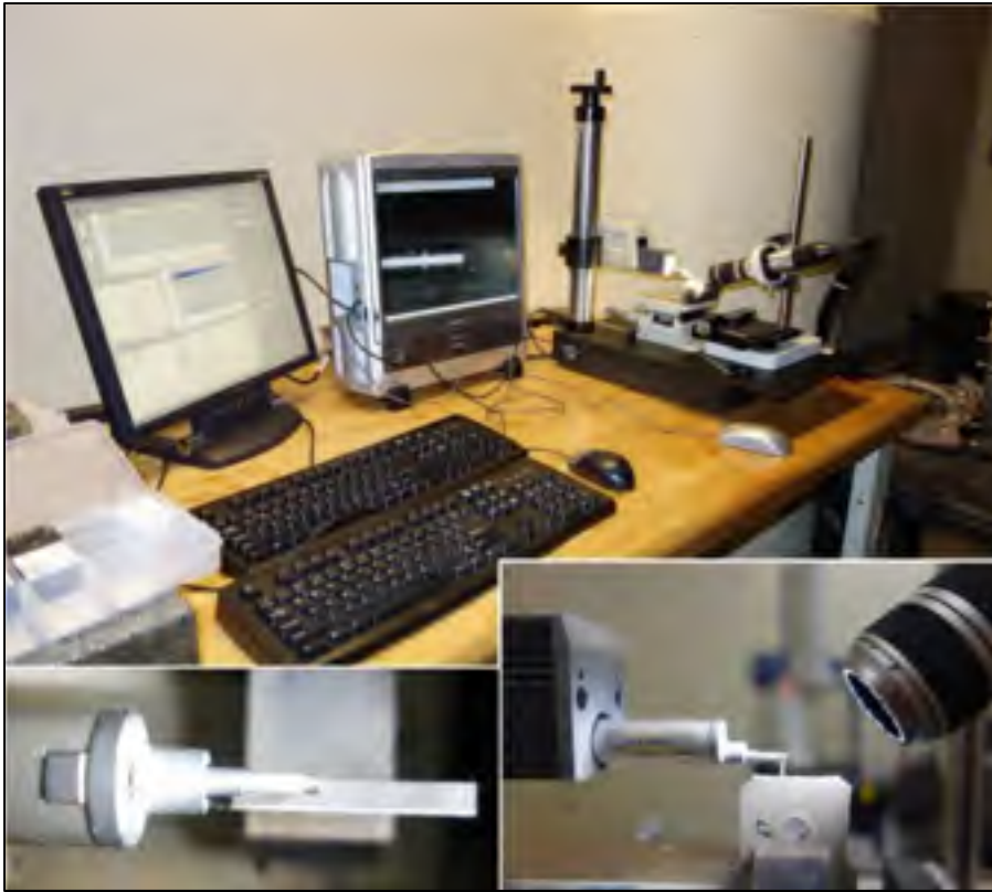
Figure 3.69 Montage du profilomètre et du microscope pour la mesure de rugosité
