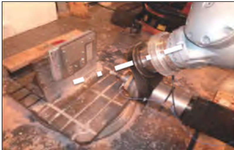
Figure 1.19 Alignement du point d'application des efforts de coupe avec l'axe 6 du robot Tirée de (Dumas et al., 2011c)
