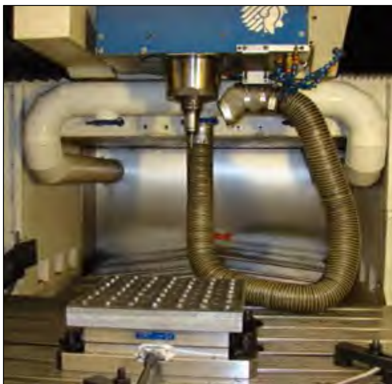
Figure 2.21 Plaque CFRP, gabarit et table KISTLER installés sur centre d'usinage numérique HURON K2X10
