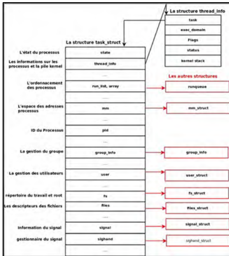
Figure 1.3 Schéma des structures de données reliées au processus Tirée de Ciliendo et Kunimasa (2007)
