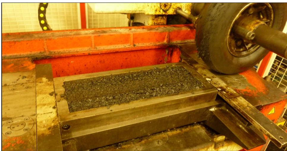
Figure 3.27 Compacteur de plaque LCPC
