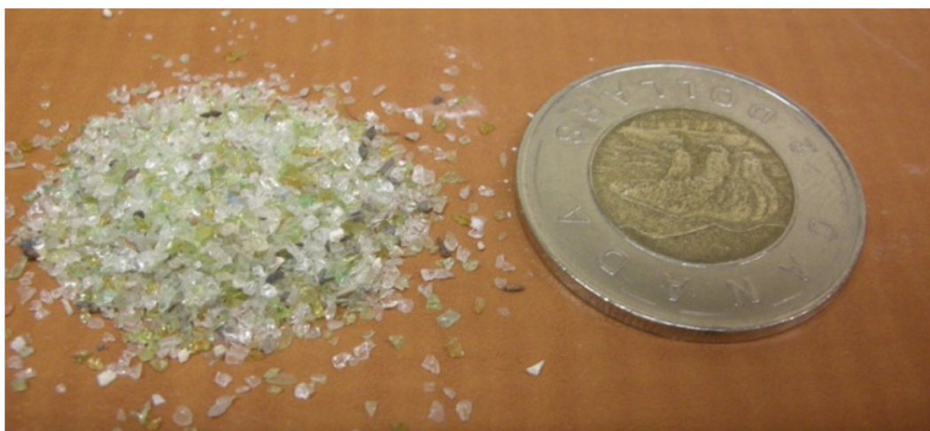
Figure 3.2 Photo du sable de verre C vis-à-vis une pièce de 2 dollars canadiens
