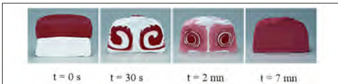
Figure 0.1.4 Exemple de mélange de deux pâtes de polymères avec le mélangeur planétaire pour les fluides. Tirée du site www.thinkymixer.net
