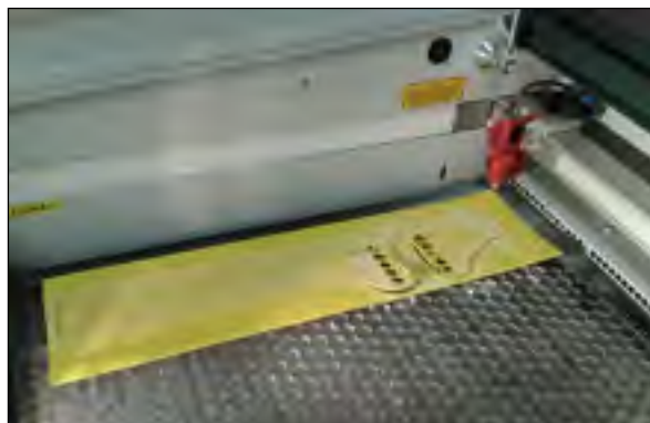
Figure 4.3 Découpage des feuilles d'HDPE avec la découpeuse laser Speedy300TM
