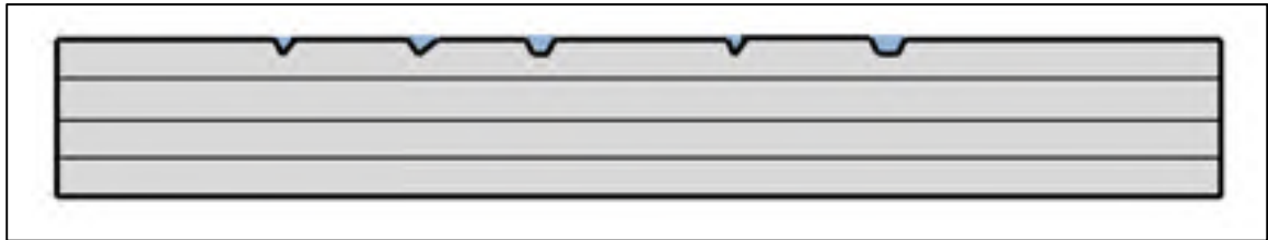
Figure 1-4 Réparation de porosité de surface
