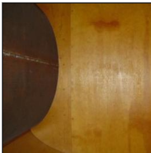
Figure-A-I-7 Filtre métallique perforé de la soufflerie Price-Païdoussis en aval du moteur.
