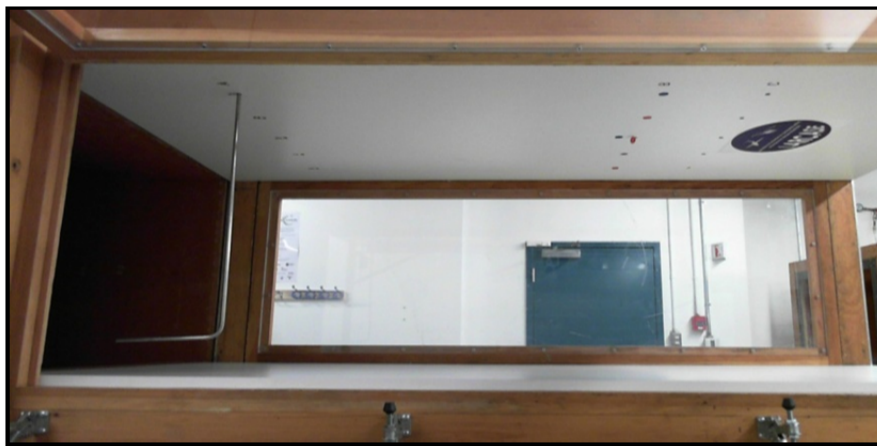
Figure 2.8 Chambre d'essai aux dimensions de (0.62 x 0.915 x 1.825) mètres
