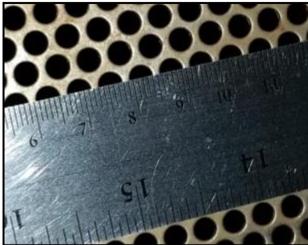
Figure-A-I-8 Dimensions du filtre métallique perforé de la soufflerie Price-Paidoussis ( d_w=4.5\text{mm} et W_m=1.5\text{mm} )
