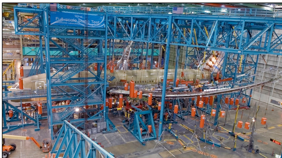
Figure 2.7 Test pleine échelle du Boeing 747-Dreamliner à l'ultime +2.5g Tirée de Boeing (2010)
