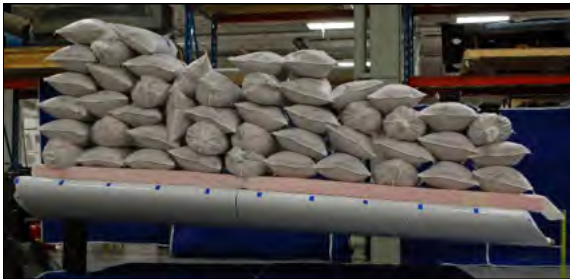
Figure 2.6 Test statique avec sacs de sable Tirée de Terrafugia (2011)
