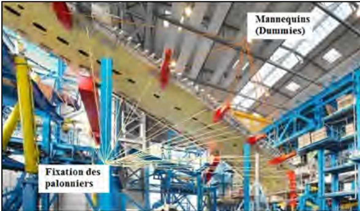
Figure 2.16 Essai à pleine échelle de l'A380 pendant son montage sur le banc d'essai Adaptée de IABG (2005)
