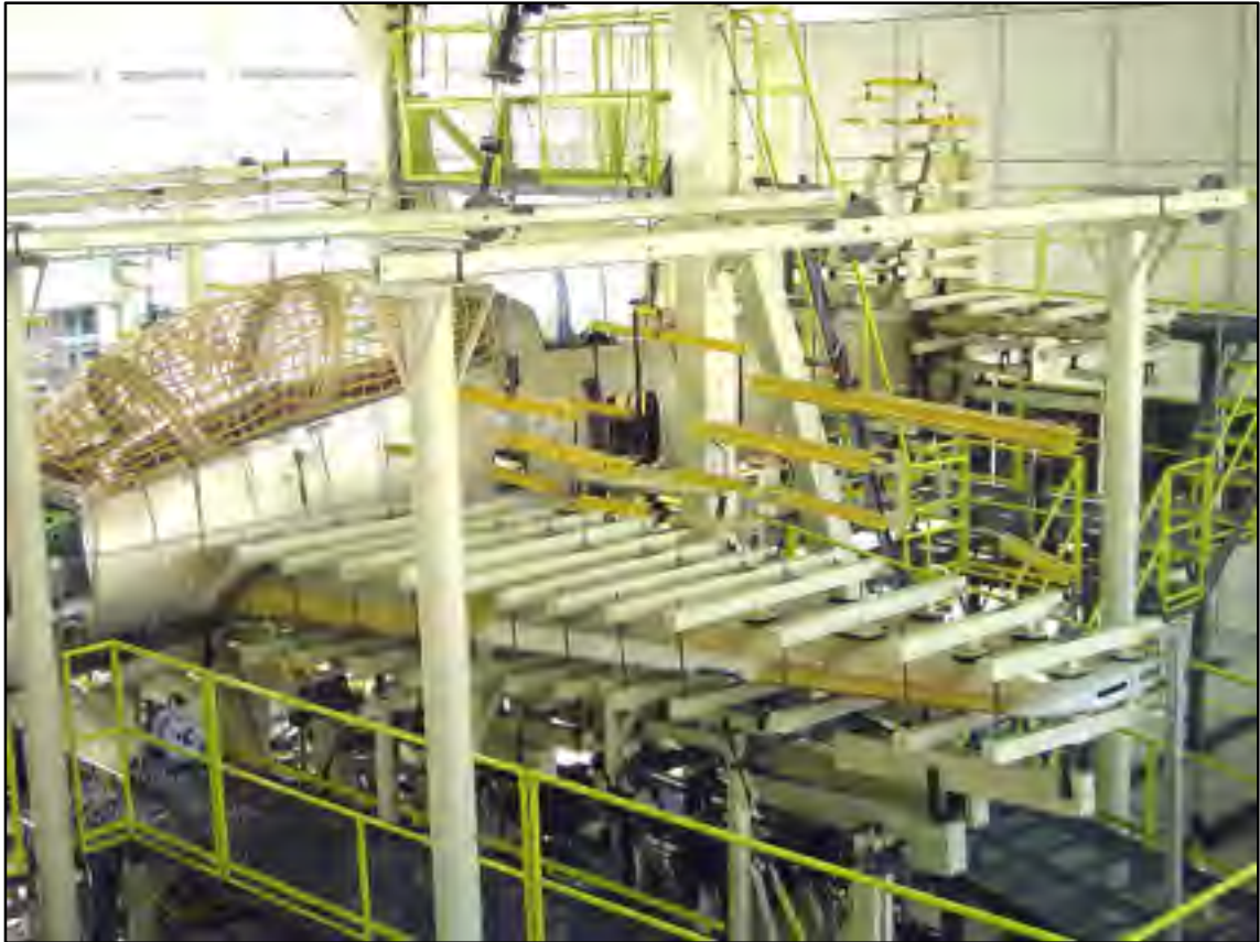
Figure 2.9 Montage typique d'un essai statique en tension Tirée de la Force Aérienne Brésilienne (2012)
