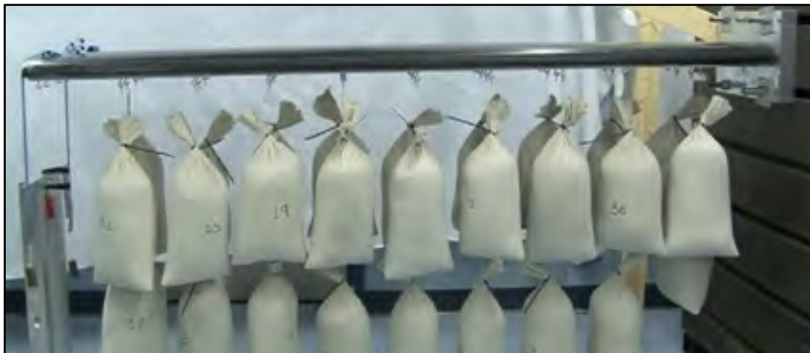
Figure 2.8 Chargement statique avec sacs de lest Tirée de Ratelle (2012, p.150)
