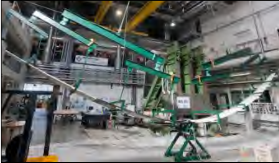
Figure 2.10 Test statique sur toute l'envergure de la voilure Tirée de l'Université de Munich (2011)
