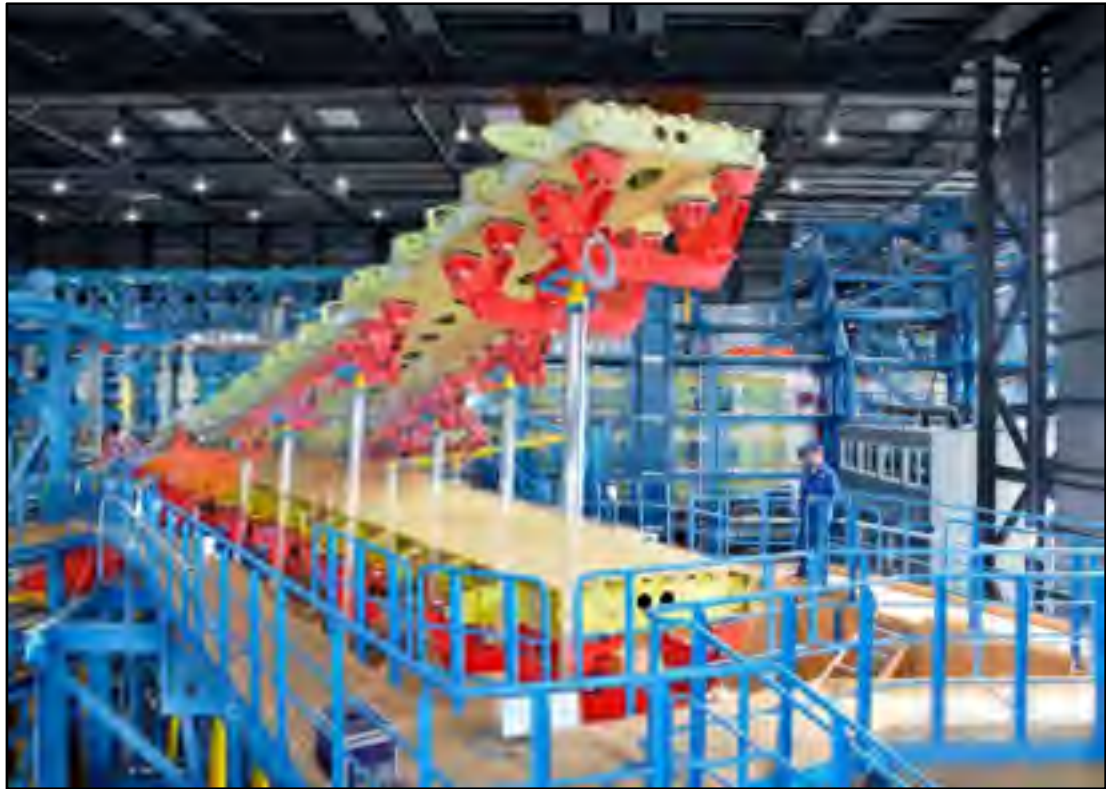
Figure 2.12 Test en fatigue du caisson de voilure de l'aile de l'Airbus A380 Tirée d'IABG (2005)
