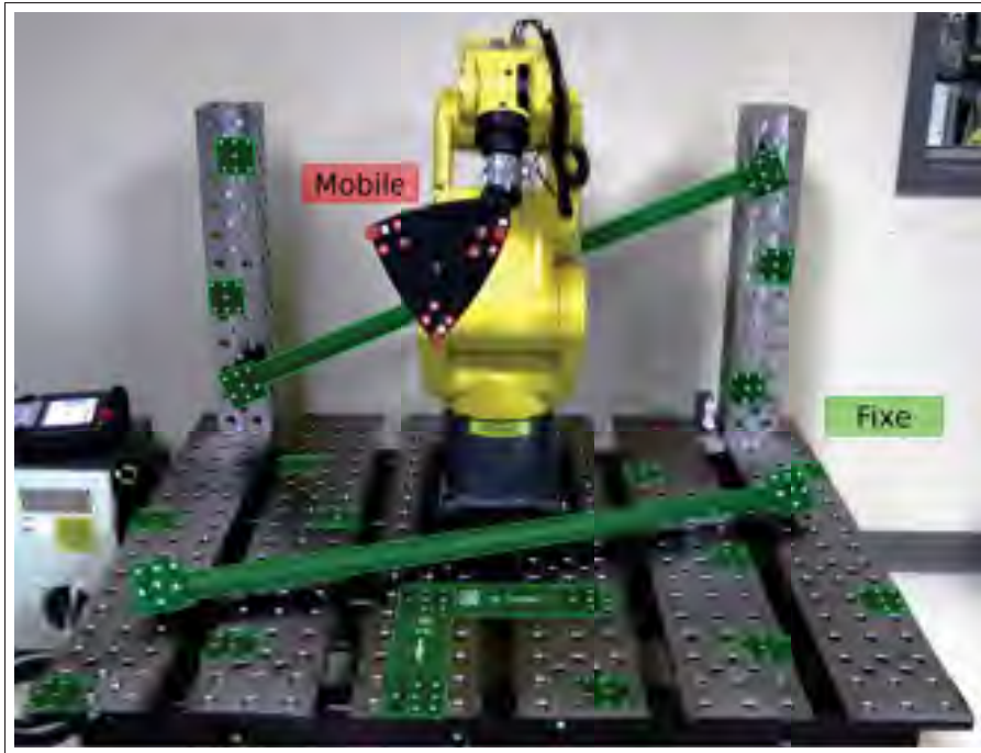
Figure 4.4 Segmentation de la scène du robot. Partie fixe en bleu et partie mobile en rouge.
