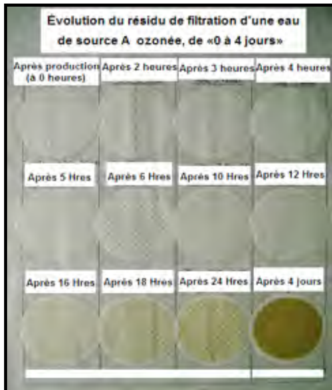
Figure-A II-3 Évolution du résidu de filtration de 0 heures à 4 jours d'un gallon d'une eau de source A naturelle, ozonée et embouteillée
