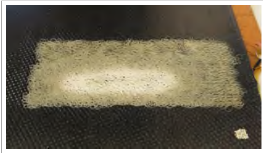
Figure 1.23 Zone sèche dû à la forte densité de touffetage Tirée de Dell'Anno (2007, p. 69)
