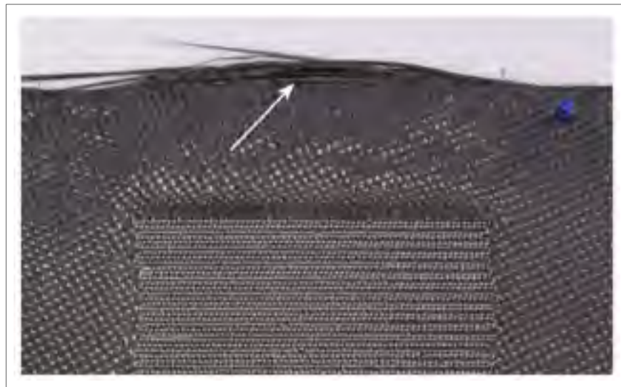
Figure 1.24 Effilochage d'un renfort lors d'un touffetage Tirée de Dell'Anno (2007, p. 29)
