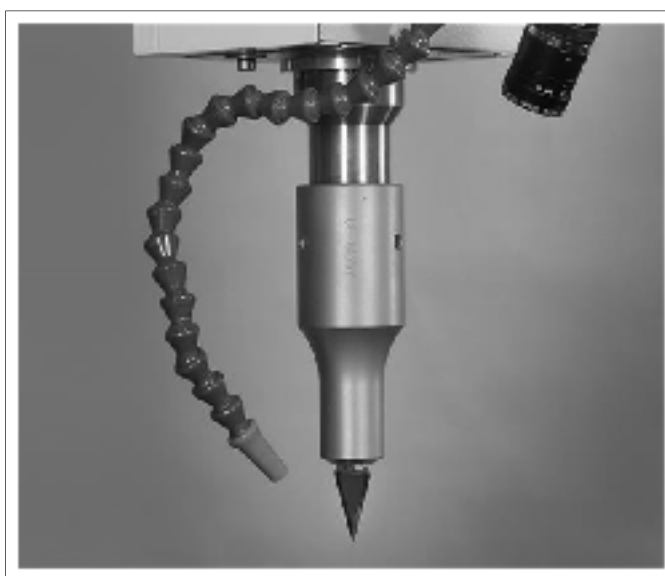
Figure 2.7 Tête de découpe ultrasonique RC590
