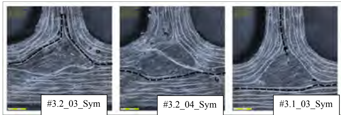
Figure 4.17 Modes de rupture pour les tests d'arrachement symétrique
