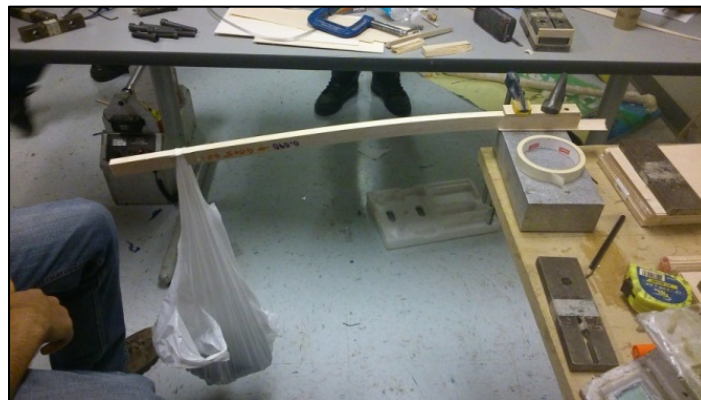
Figure 2.15 : Test de flexion sur une baguette de balsa
