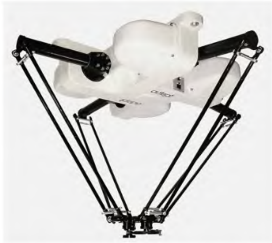
Figure 1.18 Exemple d'un robot de type parallèle : le QUATTRO de Adept.
