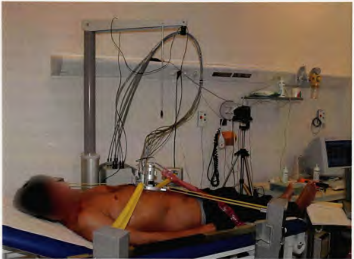
Figure 1.12 Le robot esclave de TER (Télé Écographie Robotique).
