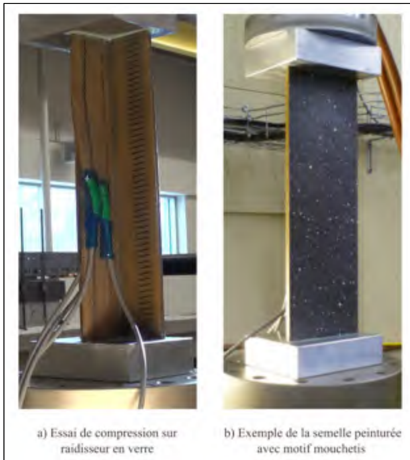
Figure 4.19 Instrumentation sur le montage de l'essai de compression
