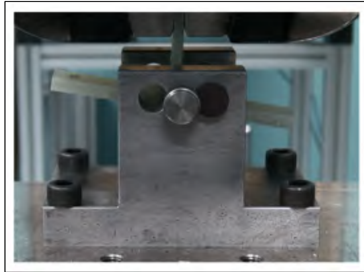
Figure 4.2 Base pour les essais d'arrachement en configuration asymétrique
