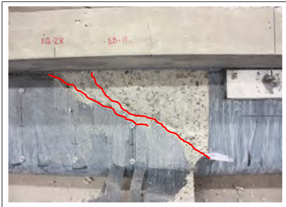
Figure 5.6 Mode de rupture du spécimen S1-EB
