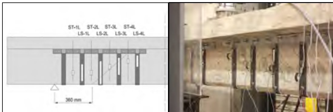
Figure 5.35 Observation du spécimen S1-LS-BA (fissure en rouge)
