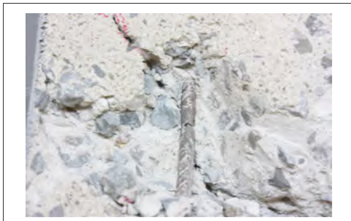
Figure 5.42 Rupture de l'étrier ST-3L pour spécimen S1-LS-BA
