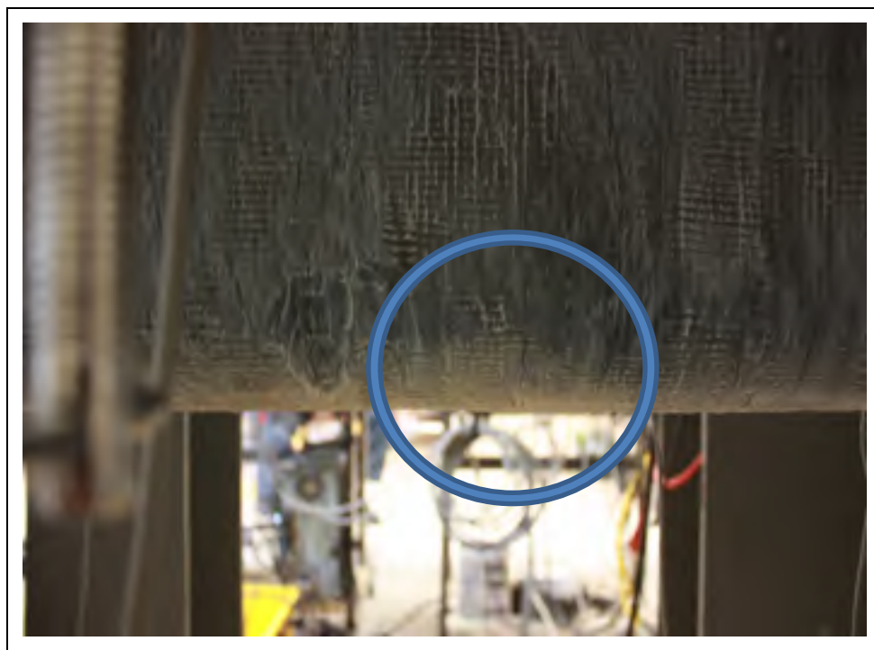
Figure 5.8 Fissure de flexion du PRFC spécimen S1-EB
