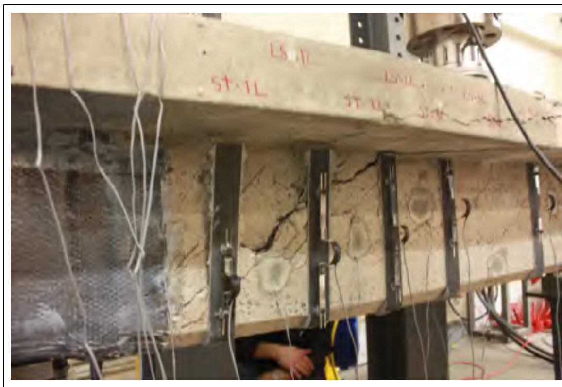
Figure 5.21 Mode de rupture du spécimen S1-LS-NA
