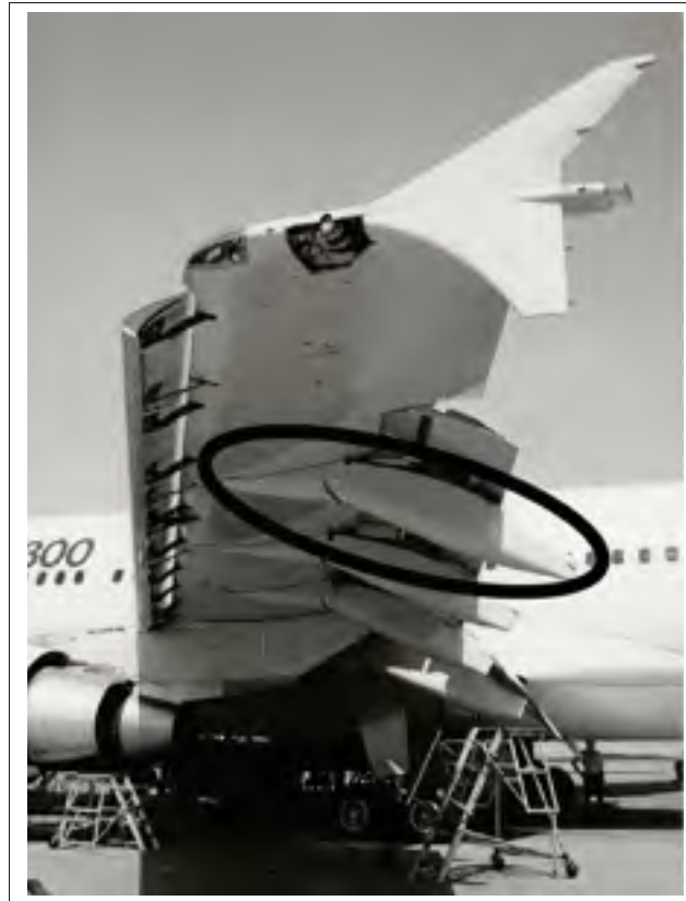
Figure 1.10 Carénage de volet sur Airbus A300 adaptée de Pingstone (2003).
