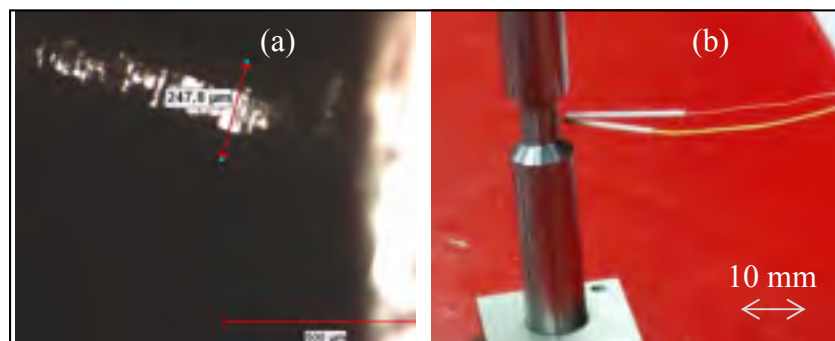
Figure 2.8 (a) Taille d'un thermocouple au microscope X100, (b) éprouvette avec un thermocouple soudé
