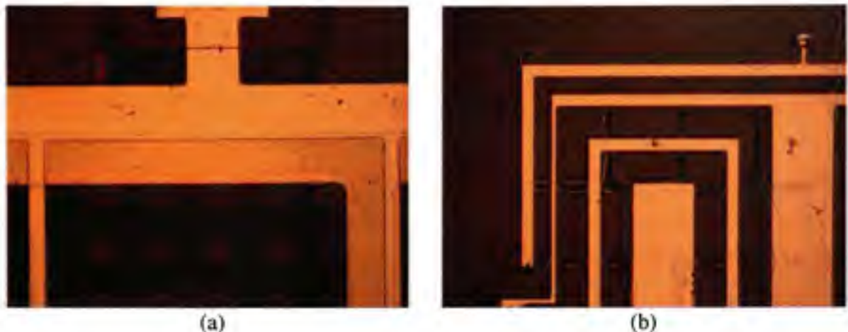
Figure 5.24 Retrait de la couche sacrificielle après 2 minutes (a) et 10 minutes (b).
