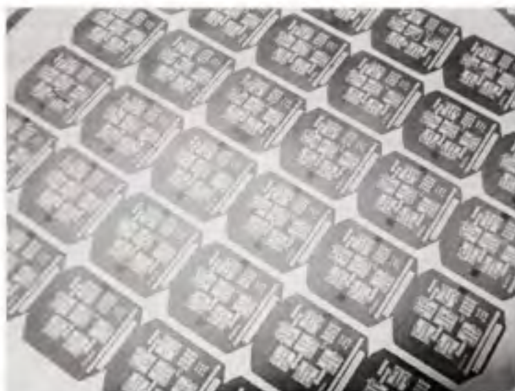
Figure 5.23 Photographie d'une tranche contenant les circuits d'adaptation MEMS.
