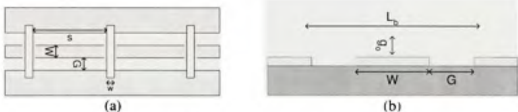
Figure 2.10 Schéma d'une ligne DMTL (a) et profil d'un interrupteur MEMS capacitif (b).
