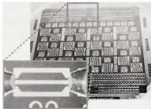
Figure 3.1 Tranche fabriquée contenant différentes lignes CPW pour la validation du modèle.
