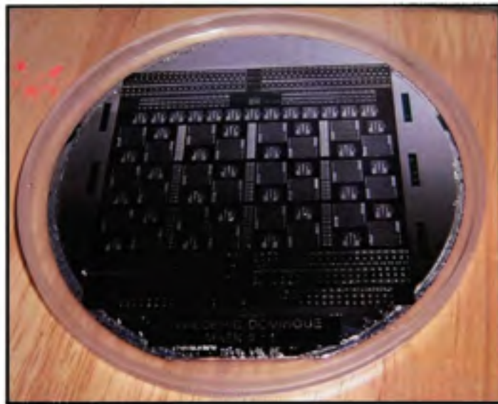
Figure 5.18 Photographie d'une tranche fabriquée selon le procédé simplifié.
