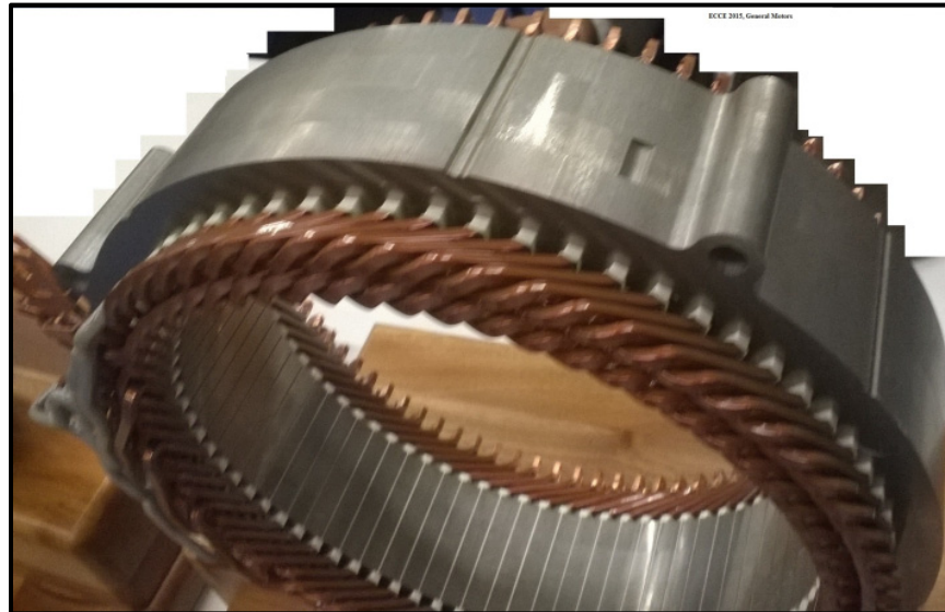
Figure 5.3 Stator d'un moteur et le trou de boulon Tirée de General moteurs, ECCE2015
