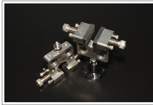
Figure 3.6 Mors utilisés pour les essais uniaxiaux.
