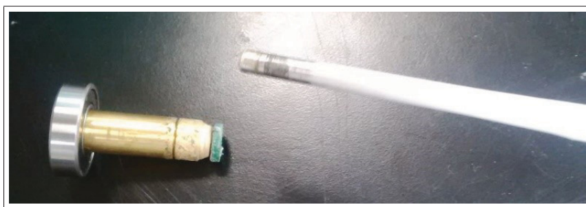
Figure 3.3 Roulement retiré du mandrin de 6 mm de diamètre suite à une déposition de fibres.
