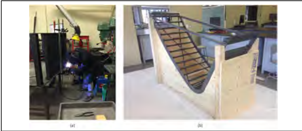
Figure 6.8 Structure en acier des modèles mâles de la dérive portante; (a) Soudage; (b) Modèle de l'extrados
