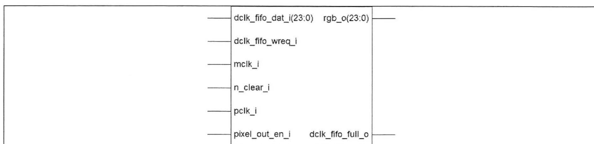
Figure 6.132 Symbole du module dclk_fifo.
