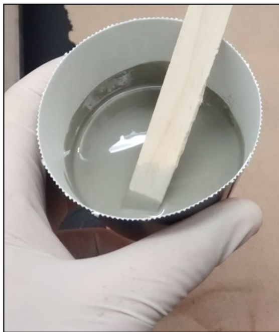
Figure 2.11 Mélange de SiC, résine et durcisseur
