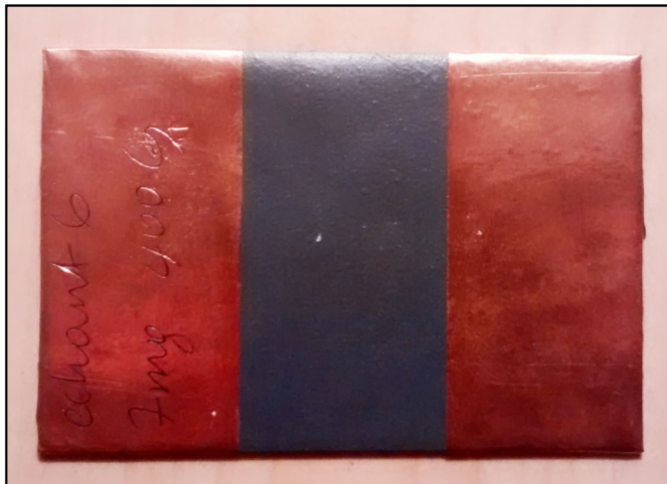
Figure 2.12 Échantillon de époxy/SiC contenant 7mg de SiC 400 G
