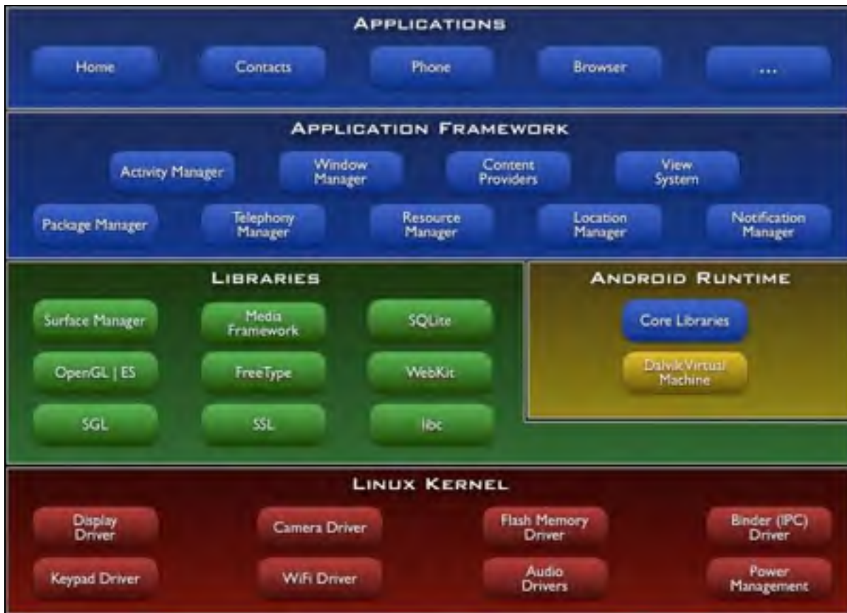
Figure 1.1 Architecture du système d'exploitation Android. Tirée de (Crussell, Gibler et Chen, 2012)
