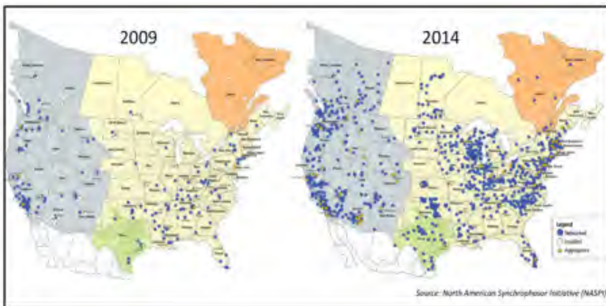
Figure 0.1 Le déploiement des synchrophaseurs à travers l'Amérique du Nord Tirée de DOE (2014, p. 3)
