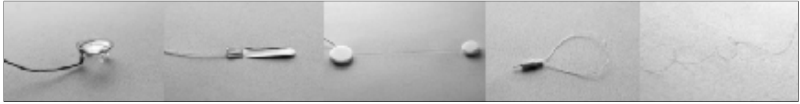
Figure 1.8 5 types d'électrodes. De gauche à droite : jet , gold foil , DTL, HK loop , Tomey fibre Tirée de Spiridonov, Rezvykh et Orlov (2011)
