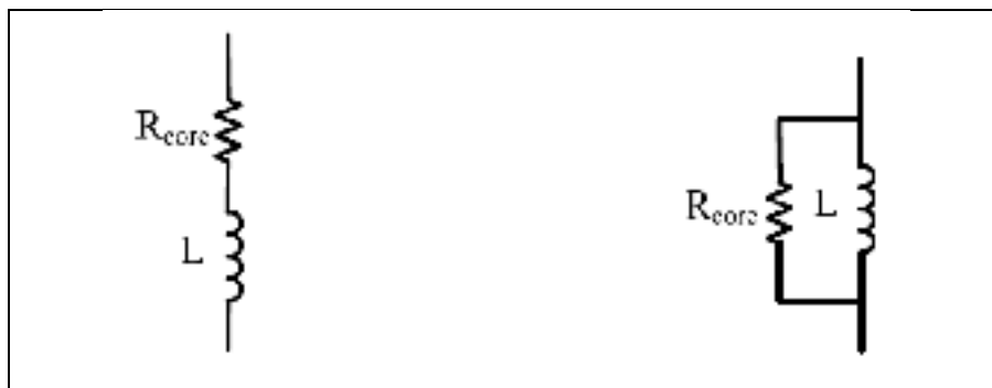
Figure 1.16 Représentations des pertes du noyau de l'inductance
