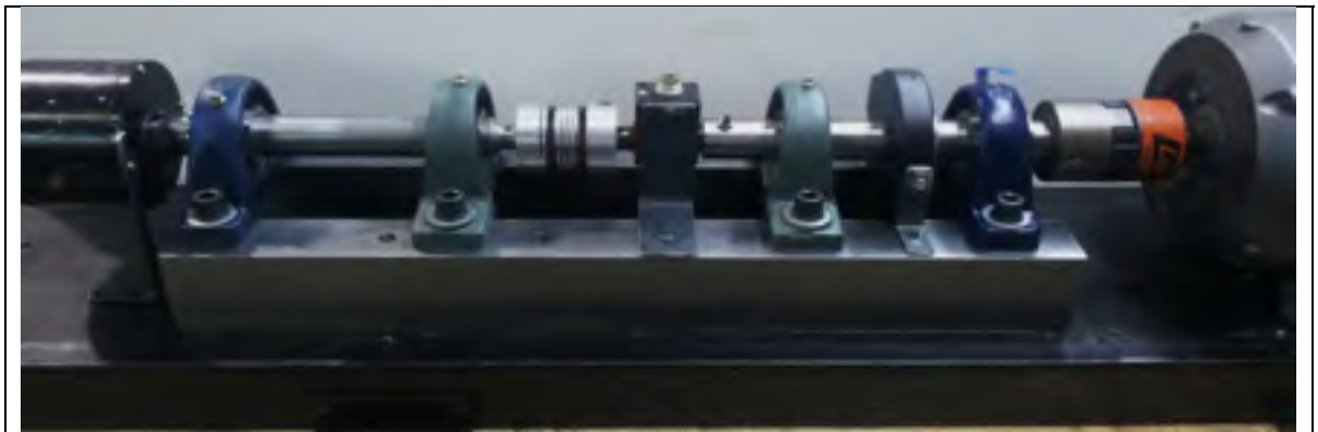
Figure 3.1 Banc dynamométrique avec le moteur Procycle en fonctionnement générateur
