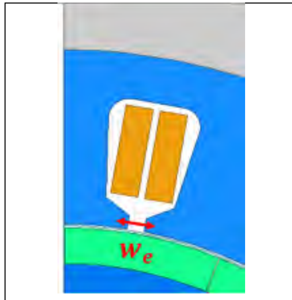
Figure 4.13 Variable dans la simulation pour la largeur de l'encoche du stator
