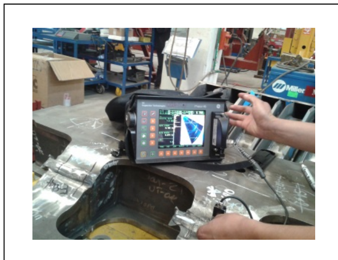
Figure 4.8 Exemple d'inspection par ultrasons multiéléments
