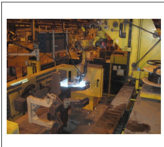
Figure 5.2 Robot de soudage du bogie
