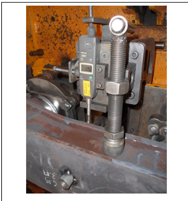
Figure 5.6 Appareil de mesure du déplacement des pièces pendant le soudage
