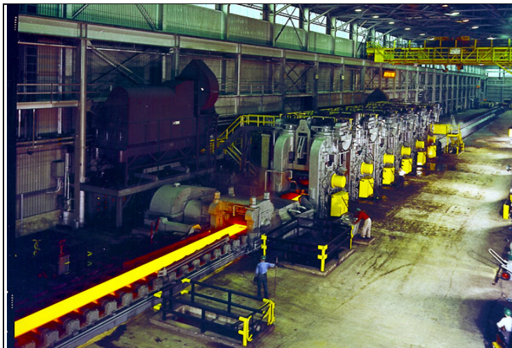
Figure 5.1 Laminiers à barres, tirée de (Mitall)
