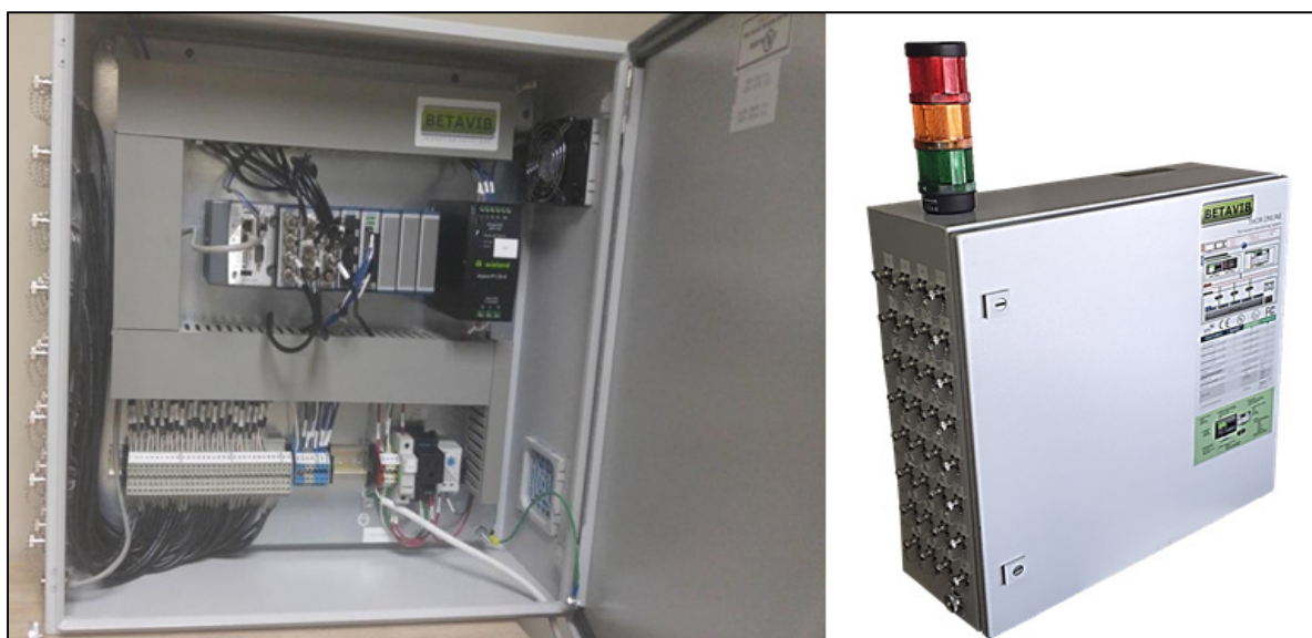
Figure 6.4 Prototype réalisé et intérieure de l'armoire électrique
